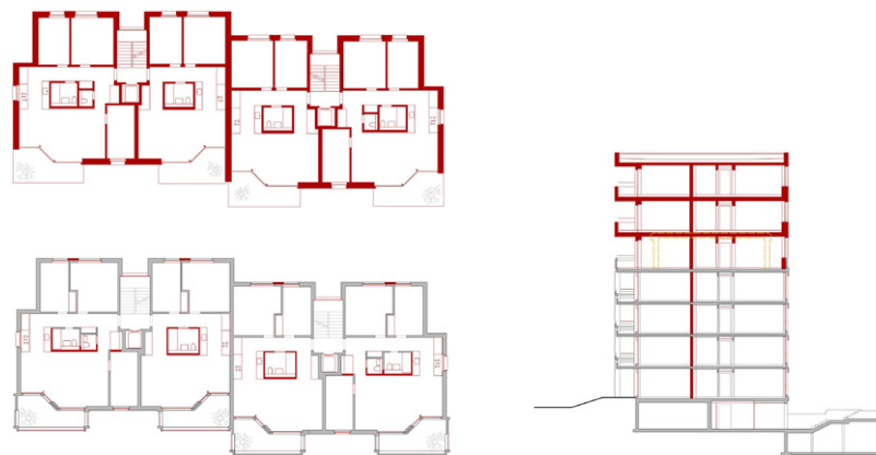
Grundrisse (Aufstockung wie Bestand) und Querschnitt
