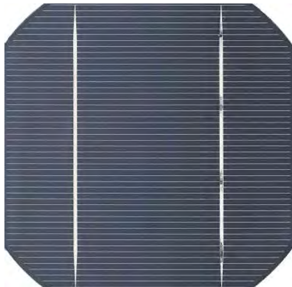
Monokristalline Zelle mit typischen beschneiten Ecken (Abb. 16)
